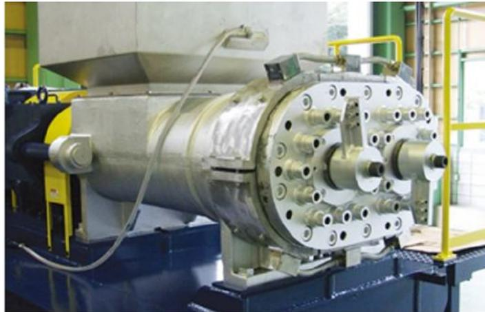
Spuckstoff und Faserschlamm mit Wassergehalt von über 60% wird auf bis zu unter 30% entwässert. Durch die Kompression und Reibungskraft der Doppelschnecken werden die Stärke- und Kunststoffkomponenten miteinander verschmolzen und zu einem festen Granulat verfestigt. Die Pellets erreichen so am Ausgang des OGUMA Spuckstoffextruders Temperaturen von bis zu 95°C. Bakterien und Pilze werden abgetötet.
