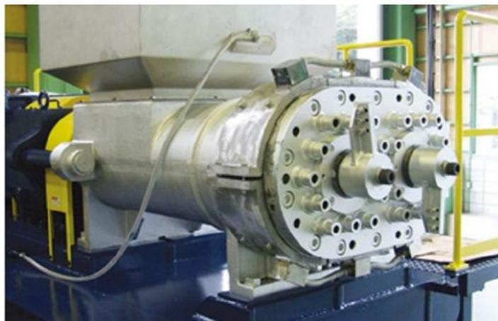
Spuckstoff und Faserschlamm mit Wassergehalt von über 60% wird auf bis zu unter 30% entwässert. Durch die Kompression und Reibungskraft der Doppelschnecken werden die Stärke- und Kunststoffkomponenten miteinander verschmolzen und zu einem festen Granulat verfestigt. Die Pellets erreichen so am Ausgang des Ogumazer Temperaturen von über 70°C bis zu 95°C. Bakterien und Pilze werden abgetötet.
