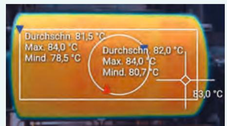
Abb. 18: Thermographie eines Betriebsversuch zur Profilierung bei 100 % Leistung. Die Maschine fuhr nur um 3,5 % nach vorne, nicht die erwarteten 10 % bis 14 %. Der führerseitige Rand ist knapp 9°C wärmer<sup>22</sup>
